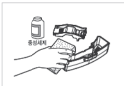
3 밥물고임방지 배수로캡 및 물받이는 물기를 제거한 행주로 닦거나 주방용 중성세제 및 스폰지로 세척해 주십시오.
