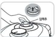
1 뚜껑 결합 손잡이를 "고압" 방향으로 돌린 후 압력추를 잡고 위로 올려서 화살표 방향(반시계 방향)으로 돌려서 분리합니다.
