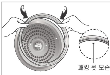
⑤ 분리형커버에 패킹을 장착시킬 경우 패킹 뒷부분의 홈에 가장자리를 끼운 후 한바퀴 돌리면서 장착합니다.
